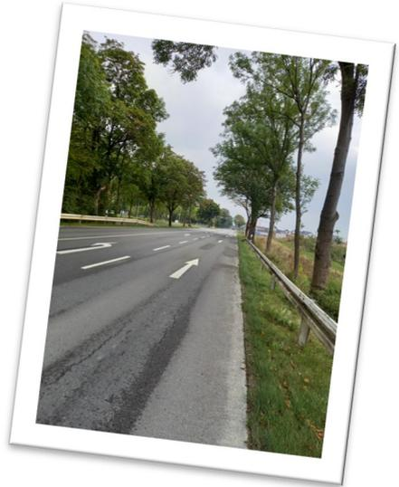
Der Radverkehr soll zwischen Auf der Lieth/Weißdornweg und Kaukenberg/Bergmann-Michel-Straße künftig in beide Fahrrichtungen auf Radfahrstreifen geführt werden. Dafür werden die vorhandenen Abbiegespuuren eingekürzt und die Fahrspurbreiten angepasst. Der Fußverkehr wird weiterhin abgesetzt von der Driburger Straße geführt.
